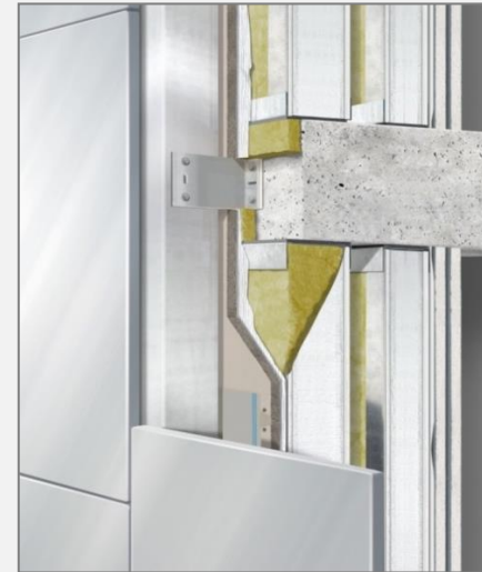
Doppelständer- konstruktion mit Vorhangfassade
