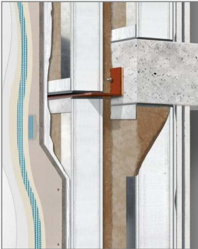
Doppelständer- konstruktion vorgestellte Montage
