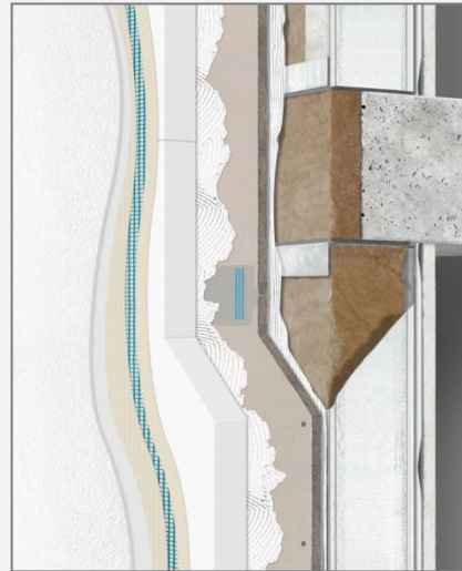
Einfachständer- konstruktion mit WDVS
